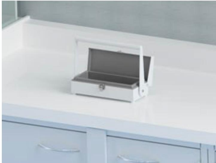
Maletín para el transporte de jeringas cargadas y/o pequeñas fuentes radiactivas. Todos los modelos están fabricados en acero con blindaje de plomo (3 ó 6 mm. de eq. Pb dependiendo del modelo) y cuentan con una bandeja interna de plástico que es extraíble para su descontaminación.
