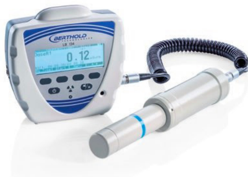
LB 134 con sonda LB 1236-H10 para rayos X y Gamma
